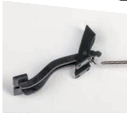
Обратите внимание: при дальнейшем монтаже собранного pedalного узла на обивку перегородки моторного отсека свободный конец пружины педали тормоза должен быть вставлен в отверстие накладке кронштейна педалей.
