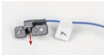
Установите выключатель стоп-сигнала внутрь кронштейна выключателя таким образом, чтобы провод отходил от выключателя в сторону более длинной крепежной проушины. Кнопка выключателя при этом должна быть направлена внутрь кронштейна.
