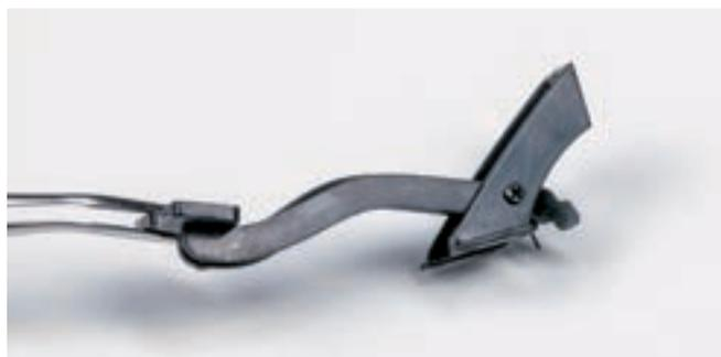
Собранные вместе педали привода тормоза и выключения сцепления установите внутрь П-образного кронштейна педалей. Зафиксируйте педали двумя винтами 1,5×4 (FP) внутри кронштейна. Не прилагайте излишних усилий при затягивании винтов, педали должны оставаться подвижными относительно кронштейна.
