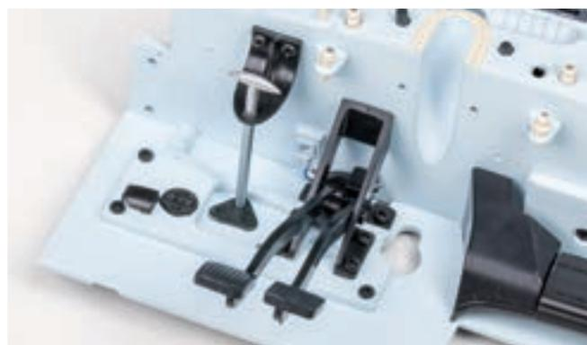
Закрепите свободный конец ручки привода центрального тормоза в отверстии установленной обивки перегородки моторного отсека. Деталь должна держаться в отверстии за счет трения.
