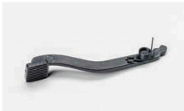
Установите пружину на ось, расположенную с левой стороны штока педали привода тормоза. Обратите внимание: нижний отогнутый конец пружины должен располагаться между двумя приливами на штоке.
